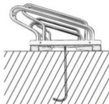
montaż za pomocą kotwy
